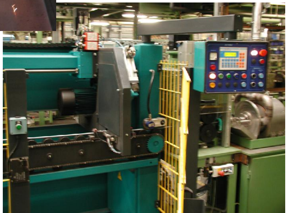
RO – fliegender Schnitt In Vergütungsanlage
